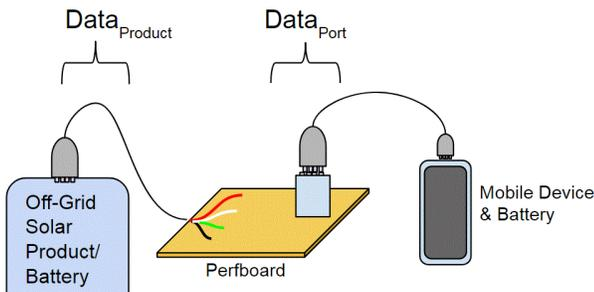
**FIGURE 2: PERFBOARD FABRICATION USED FOR DATA ACQUISITION AT THE OFF-GRID PRODUCT USB PORT**
